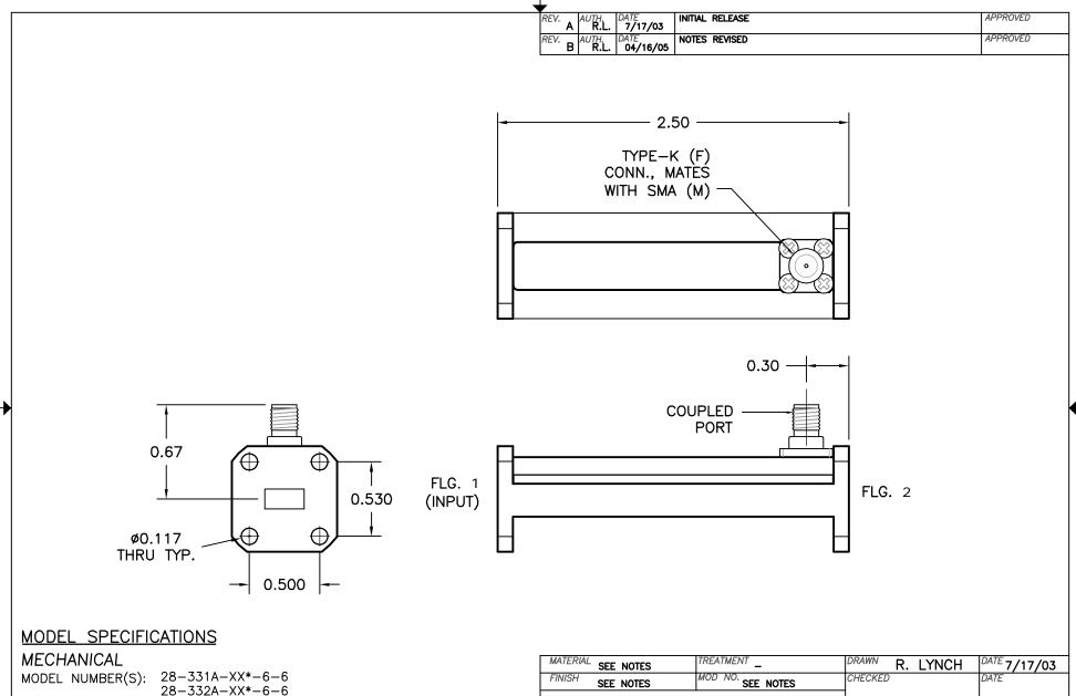
\*SUBSITUTE WITH DESIRED COUPLING VALUE (dB)
